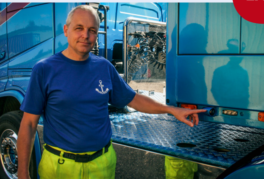
Kim Ancker peger på et af trailerens kameraer. Trækker og trailer er forsynet med i alt 11 kameraer.
